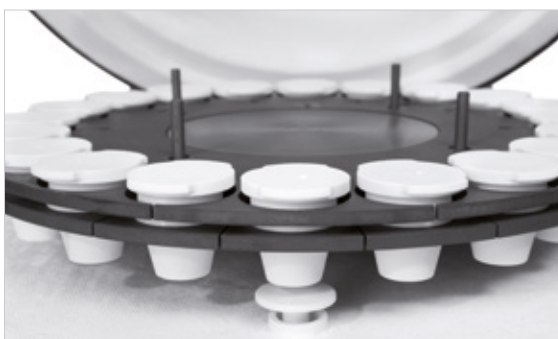
Управление компьютером крышками тиглей / тигель закрыт
