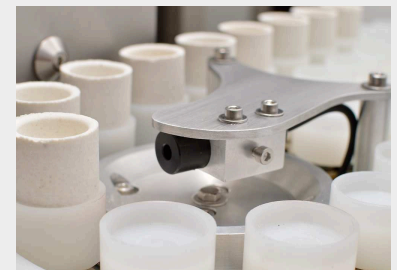
Autocarregador com suportes de cadinhos de plástico resistentes a ácidos
