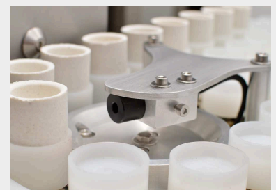
耐酸性プラスチック製のるつぼホルダーを装備したオートローダ
