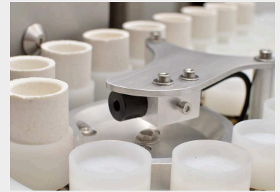
Chargeur automatique avec supports de creuset en plastique résistant à l'acide
