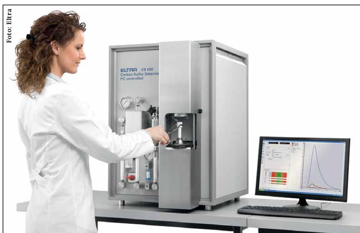
1 Der Kohlenstoff-/ Schwefelanalysator Eltra CS-800 ist ein Elementaranalysator, der eine Kombination von Probenaufschluss (Verbrennung) und Messung der freigesetzten Gase in Infrarot- oder Wärmeleitzellen darstellt
