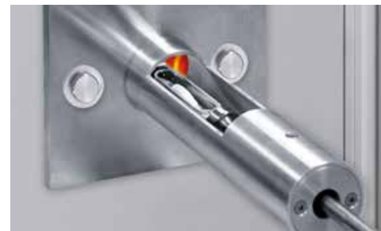
Manuelle Einführung der Probe in den Ofen über eine Probenschleuse
