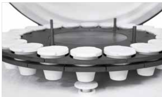
Application contrôlée par ordinateur des couvercles de creusets / creusets fermés
