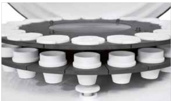
Application contrôlée par ordinateur des couvercles de creusets / creusets ouverts
