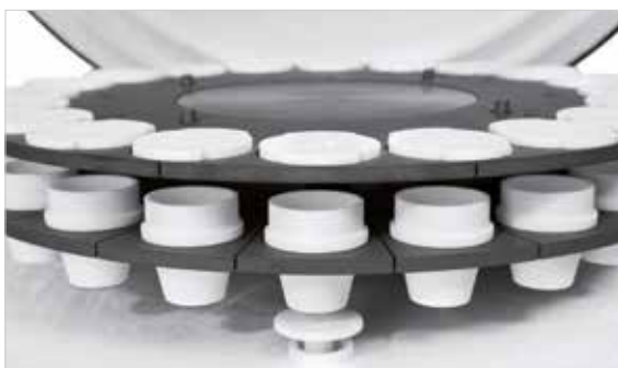
PC-gesteuerte Applizierung von Tielgeldeckeln/Tiegel geöffnet
